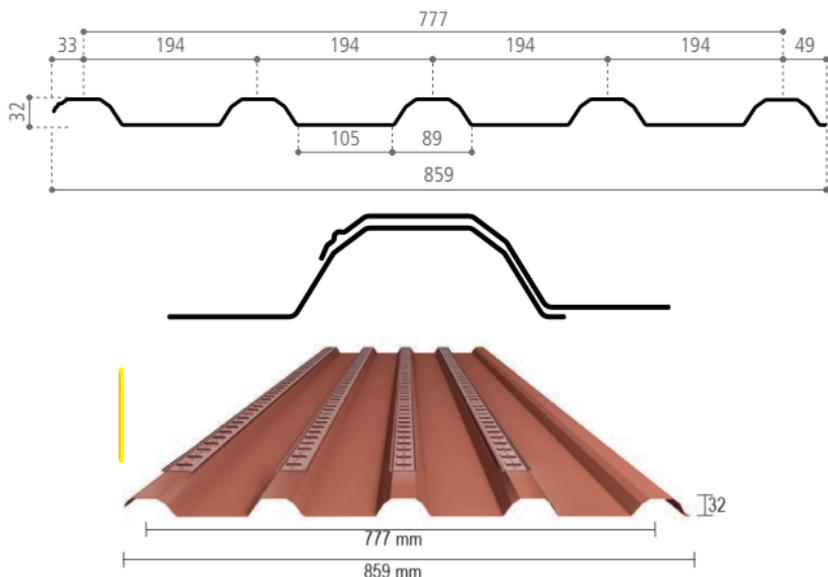
Lastra metallica grecata da sottocopertura "Sottocoppo" con sistema completo di correntino metallico sagomato (previsti n. 4 correntini per lastra) installato sulla greca alta della lastra che permette il facile e stabile ancoraggio di coppi tradizionali.
