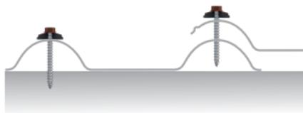
Posizione della vite in prossimità del sormonto
