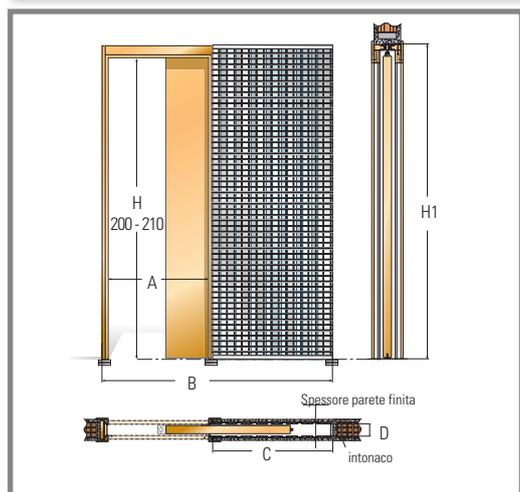
I telai **Orchidea** per laterizio sono costituiti da pannelli di acciaio zincato con passivazione easy-film top quality, profilati con grecatura a coda di rondine, che conferisce massima rigidità e permette all'intonaco di legarsi perfettamente al telaio. **Esternamente è applicata una rete già fissata al pannello** con maglia 50x100 mm, che trattiene l'intonaco uniformando la muratura.
