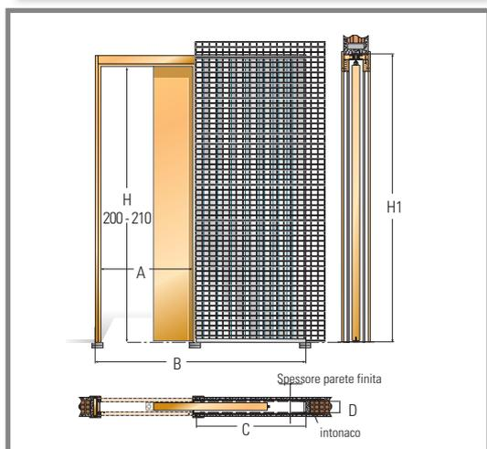
La Linea Plus per laterizio ad elevata tecnologia oltre ad avere le pareti del telaio in lamiera grecata a coda di rondine, queste sono complete di malta aggrappante (brevetto esclusivo Fibrotubi) che rende la superficie esterna rugosa, studiata per assorbire l'umidità dell'intonaco come una parete in laterizio, **riducendo così i tempi di posa e garantendo il massimo risultato estetico.**
