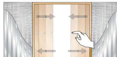
Il kit apertura/chiusura simultanea consente di aprire o chiudere agevolmente e con un solo gesto le due ante di un sistema ad anta doppia. Può essere installato anche quando il telaio è già stato montato.
