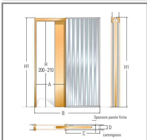
Il telaio per cartongesso si compone di pannelli in acciaio zincato con passivazione easy-film top quality, profilati a coda di rondine con grecatura in verticale.
