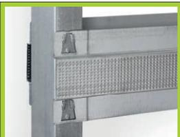
Tutte le traversine sono state studiate e prodotte con micropunzonatura per facilitare il fissaggio del cartongesso, inoltre i ganci posti sulle traversine consentono un fissaggio rapido.
