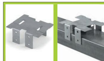
Le staffe distanziatrici poste sulla traversa superiore permettono di centrare e fissare agevolmente i profili in cartongesso da 75 mm.
