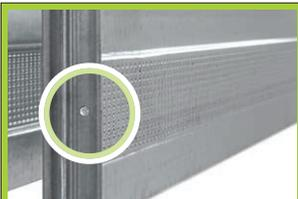
In corrispondenza di ogni traversina orizzontale del telaio, vi è un foro che permette di identificare la giusta posizione per il fissaggio delle viti nella lastra in cartongesso una volta che queste abbiamo già ricoperto le traversine.
