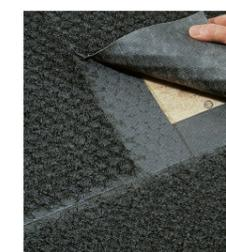
Membrana impermeabile aperta alla diffusione del vapore con separatore drenante per la microventilazione di coperture metalliche. Con doppia banda adesiva integrata. Riduce il rimbombo acustico provocato da pioggia e grandine.
