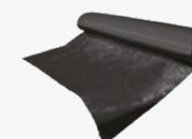
Membrana traspirante in tessuto non tessuto, impermeabile all'acqua e altamente traspirante. Grazie alla sua alta permeabilità al vapore acqueo è ideale sia su tetti ventilati che non: l'umidità residua proveniente dai locali di temperatura maggiore può così essere evacuata senza ritorno verso il pacchetto di copertura.
