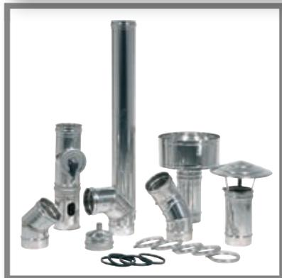
Condotto mono parete idoneo per l'evacuazione di fumi umidi, secchi, in pressione o depressione adattabile ad ogni situazione. Innesco calibrato maschio - femmina con fascetta di bloccaggio. Realizzato in acciaio inox 1.4404 (AISI 316L) finitura BA, di spessore nominale 0,5 mm
