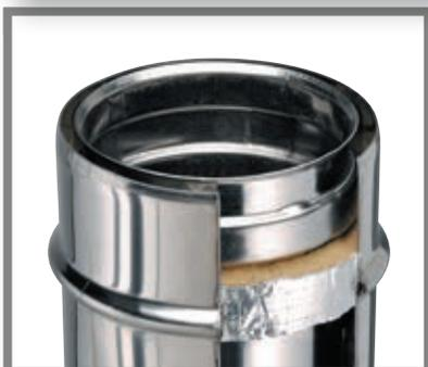
Elementi prefabbricati a doppia parete con isolamento ottenuto mediante una camera d'aria statica di spessore 10 mm. Innesto calibrato maschio - femmina con fascetta di bloccaggio. Parete interna in acciaio inox AISI 316L finitura BA spessore 0,5 mm. Parete esterna in acciaio inox AISI 304 finitura BA o con verniciatura in rame martellato o nei colori RAL.
