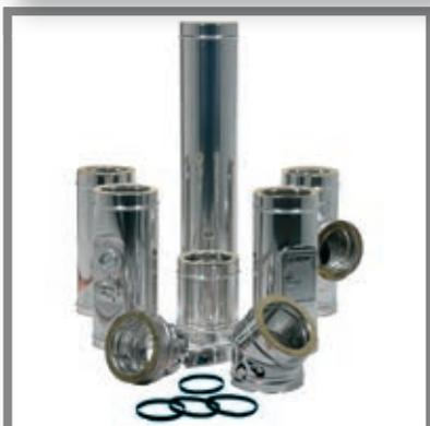
Sistema camino a doppia parete per l'evacuazione di fumi umidi, secchi, in pressione o depressione. Spessore coibentazione 25 + 25 mm. Innesto calibrato maschio - femmina con fascetta di bloccaggio.
