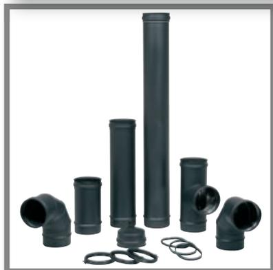
Sistema modulare ad innesto a bicipiede, con fascietta di bloccaggio. Prodotto in acciaio inox 1.4404 (AISI 316L) verniciato opaco grigio scuro, avente spessore nominale 0,5 mm. Resistente al calore ed alle inevitabili alterazioni cromatiche, grazie alla vernice utilizzata che ha una funzione estetico-tecnica. Il fissaggio a forno della stessa, infatti, rende MAT BLACK resistente alle alte temperature, a deterioramenti e a variazioni di colore.
